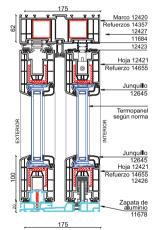
ACRISTALAMIENTO: DESDE 4mm HASTA 44mm DE ESPESOR. DISEÑO 8 CÁMARAS DE AISLACIÓN EN MARCO. CIERRES MULTIPUNTO. HERRAJES ESPECIALES (Hasta 400Kg por hoja). REFUERZO DE ACERO. PROFUNDIDAD CONSTRUCTIVA 175 mm. MÁXIMO 12 M2 Ó 400 KG POR HOJA. VALIDAR MEDIDAS MÁXIMAS SEGÚN MANUAL TÉCNICO Y DE FABRICACIÓN.
