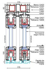
ACRISTAL AMIENTO: DESDE 4mm HASTA 44mm DE ESPESOR. DISEÑO 8 CÁMARAS DE AISLACIÓN EN MARCO. CIERRES MULTIPUNTO. HERRAJES ESPECIALES (Hasta 400Kg por hoja). REFUERZO DE ACERO. PROFUNDIDAD CONSTRUCTIVA 175 mm. MÁXIMO 12 M2 Ó 400 KG POR HOJA. VALIDAR MEDIDAS MÁXIMAS SEGÚN MANUAL TÉCNICO Y DE FABRICACIÓN.
